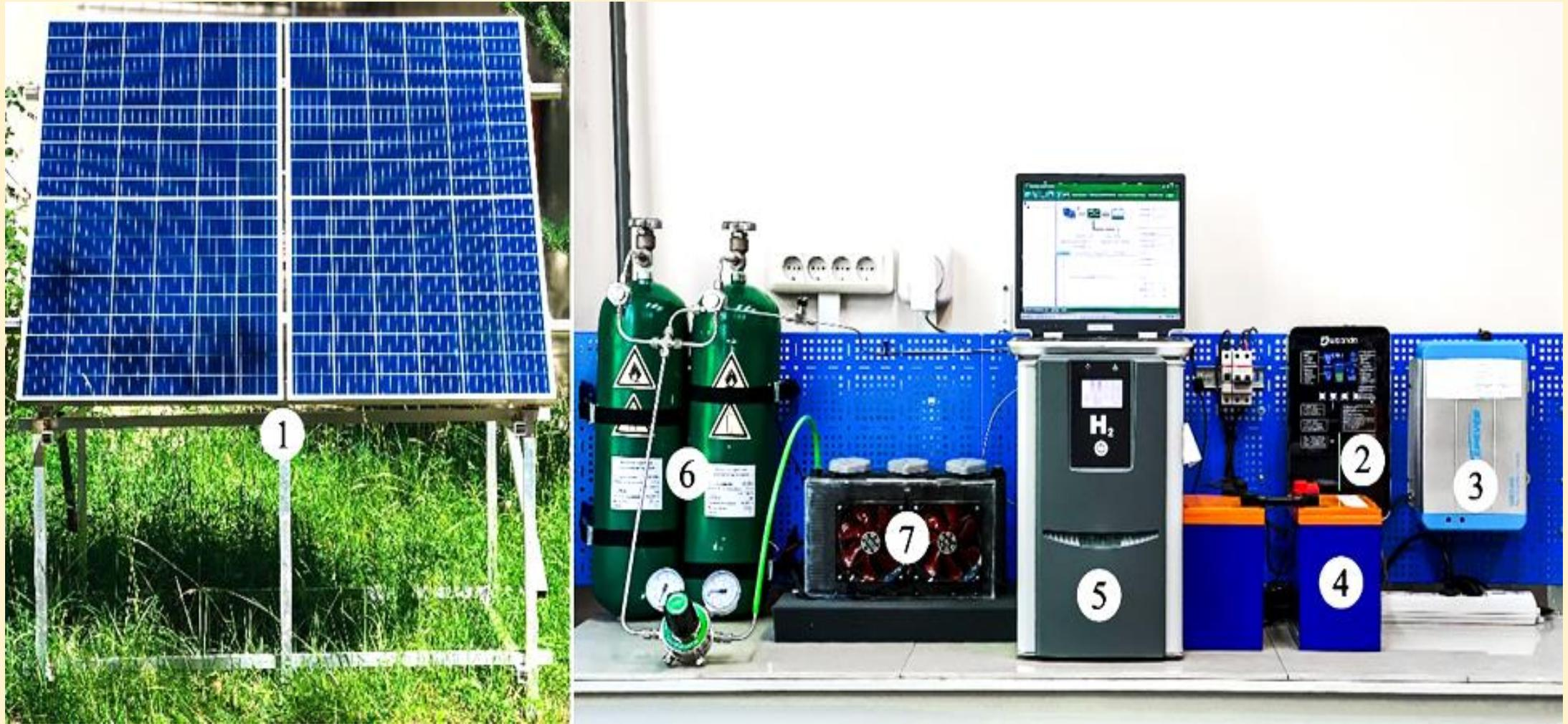
1 – Солнечные панели SRP-280-BPB, 2 – Контроллер заряда Wipanda MPPT Solar Charge Controller, 3 – Инвертор EPsolar Epever SH1000-22, 4 – Аккумуляторы Delta HRL 12-55, 5 – генератор водорода HG Pro 1500, 6 – Металлогидридный аккумулятор водорода, 7 – Топливный элемент Ballard FCGen 1020ACS.
