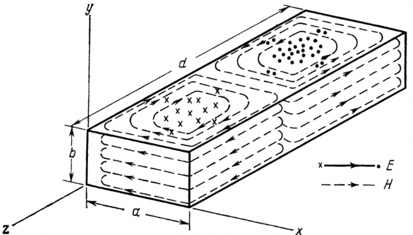
Структура электромагнитного поля в прямоугольном резонаторе с модой TE<sub>102</sub>.
