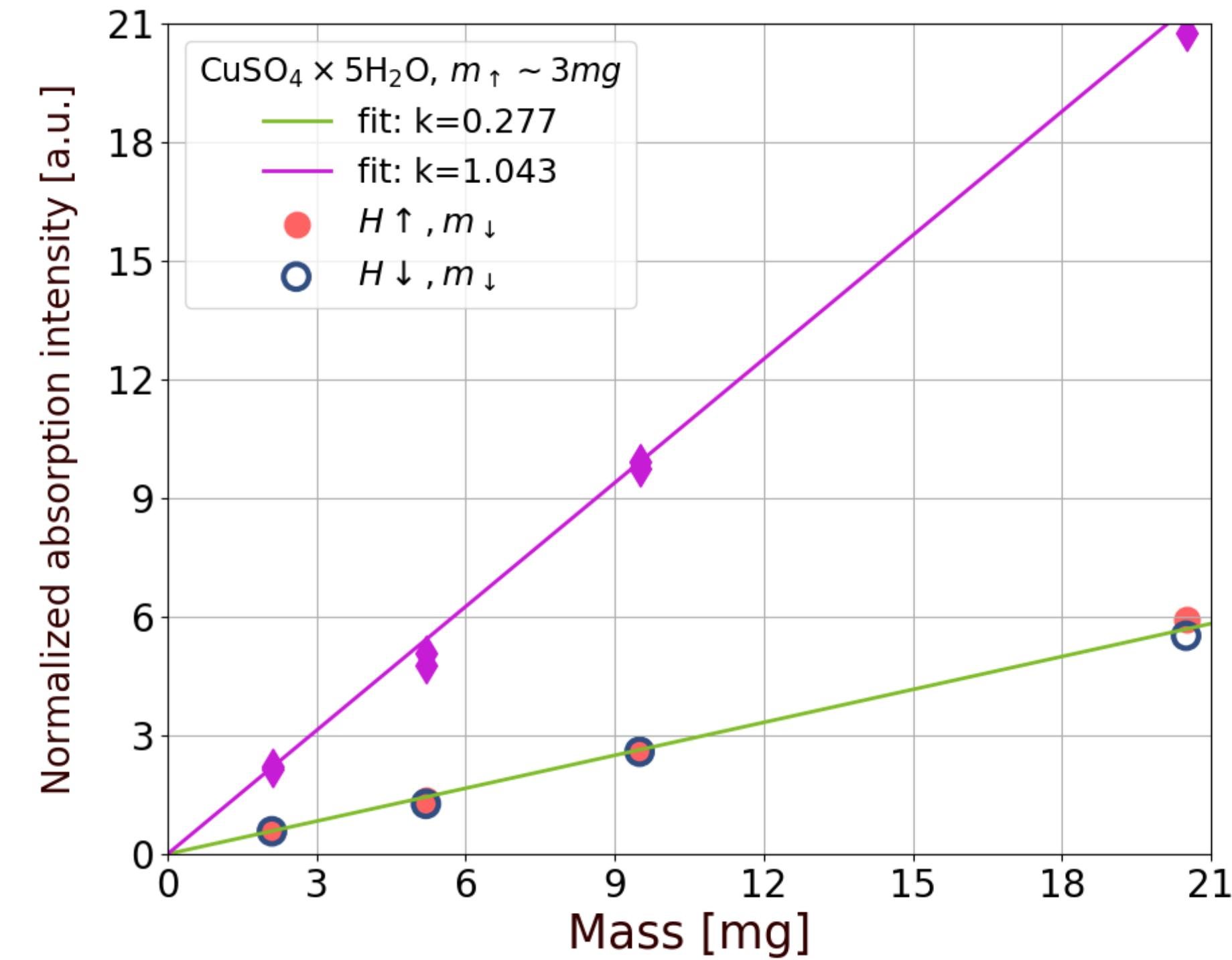
Для проведения калибровки использована неоднородность поля в магните. В резонатор помещается два образца – один в штатное место на нижнем фланце резонатора, второй – в симметричное место на верхнем фланце резонатора (высота ~ 40 мм).
