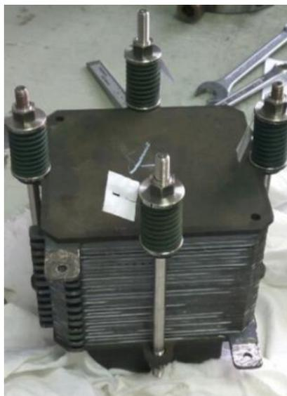
Батарея ТОТЭ мощностью 500 Вт
