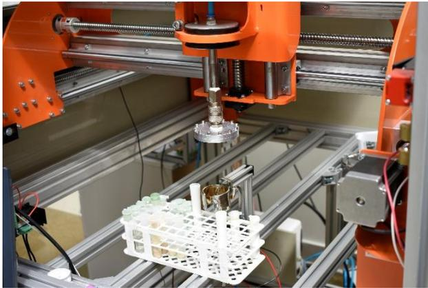
Установка (дипкоутер) для нанесения функциональных слоев микротрубчатого ТОТЭ
