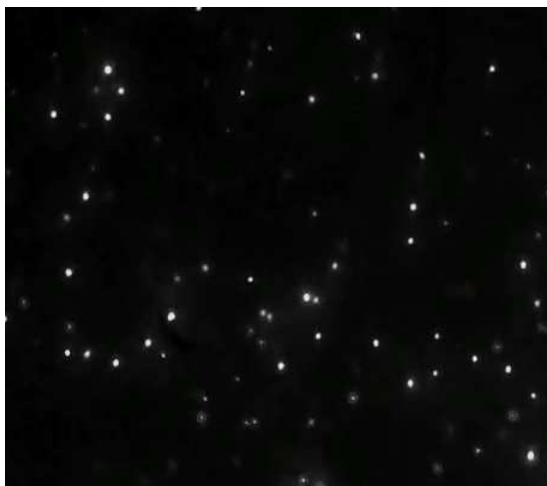
Рис. Характерный вид поля зрения ультрамикроскопа. Водный раствор латексных наночастиц радиусом 135 нм.
