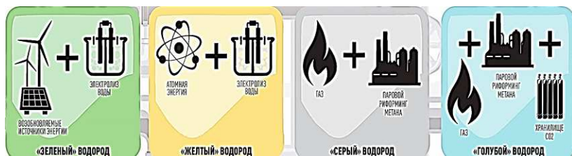
Рис. 3. Классификация водорода по способам производства
