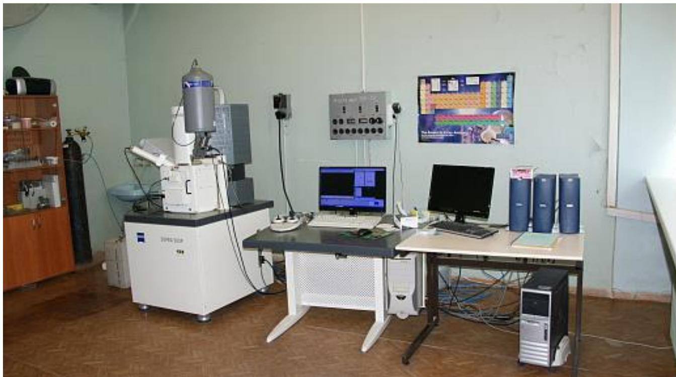
Сканирующий электронный микроскоп (СЭМ) высокого разрешения
