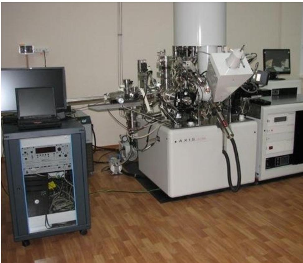
Спектрометр Kratos AXIS Ultra DLD предназначен для исследования поверхности в сверхвысоком вакууме и позволяет получить следующую информацию:
