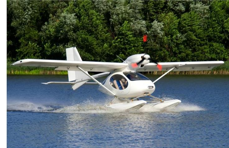
Пилотируемый самолет «Сигма-4» на ТЭ, взлетная масса — 600 кг, мощность — 75 кВт, дальность полета — до 300 км.
