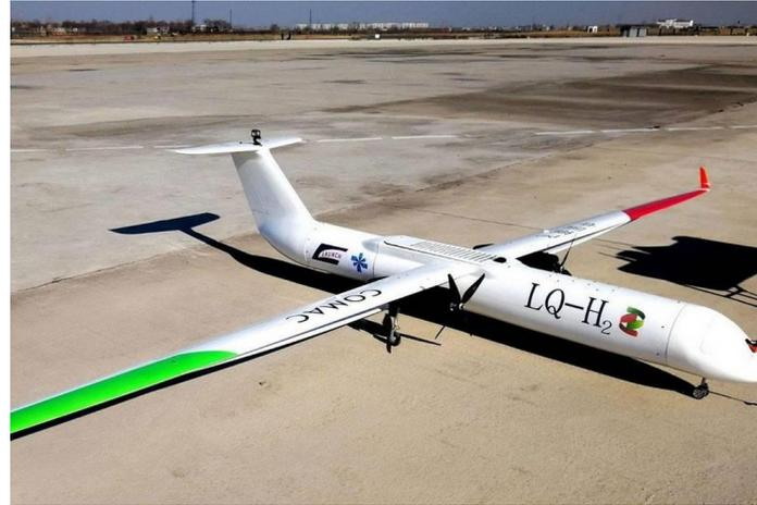
ПЛА (грузоподъемность от 50кг) на водородном двигателе мощностью 18кВт (Китай).
